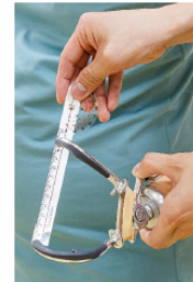
図12 手先具単体の最大開き幅の測定
