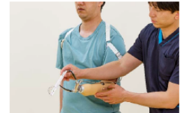
図13 肘関節 90 度屈曲位での手先具の開き幅の測定
